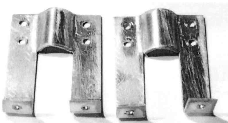
Figura 4.12. Suporte do motor vertical do protótipo.
